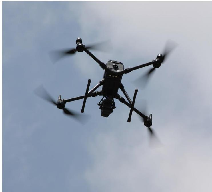
Una vez se tienen los puntos de control, se procede con la colocación de la base GNSS del dron; misma que se liga a las coordenadas levantadas previamente.
